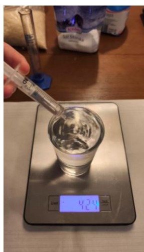
Rys 3. Pomiar objętości szklanki
